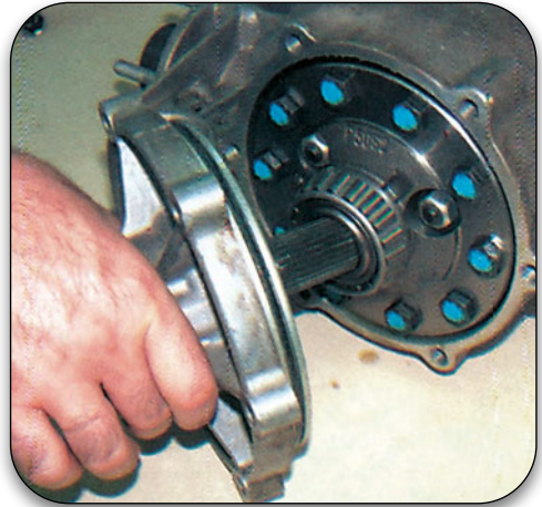
Σχήμα 1.36: Αφαίρεση καπακιού διαφορικού.
