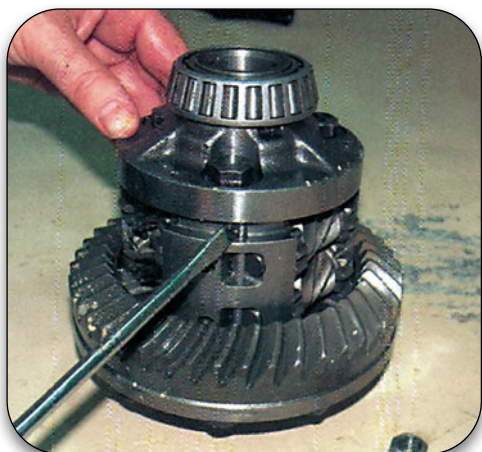
Σχήμα 1.39: Αφαίρεση καπακιού πλανητικού συστήματος.
