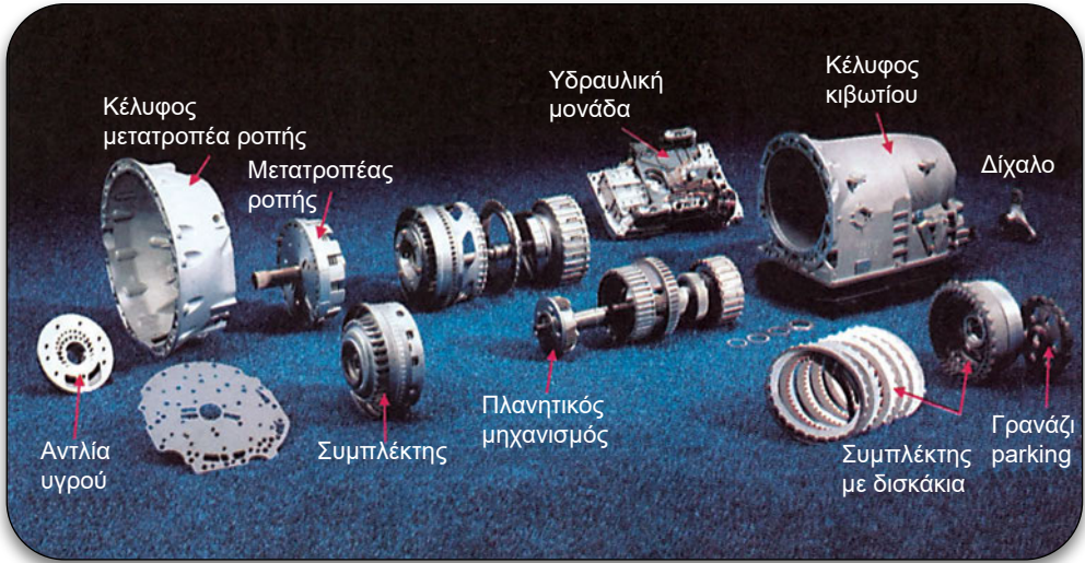
Σχήμα 1.1: Κυριότερα εξαρτήματα ενός αυτόματου κιβωτίου ταχυτήτων.
