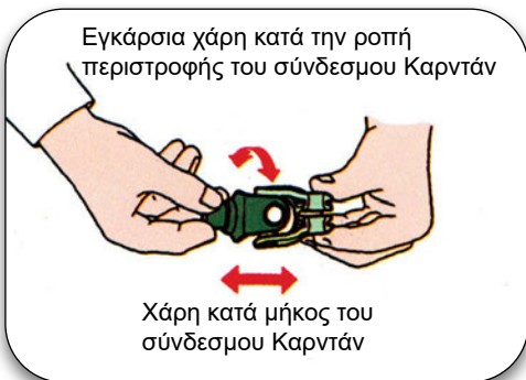
Σχήμα 2.34: Έλεγχος τζόγου συνδέσμων καρντάν.
