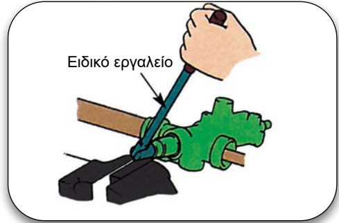
Σχήμα 2.43: Αφαίρεση βιδωτής τάπας.
