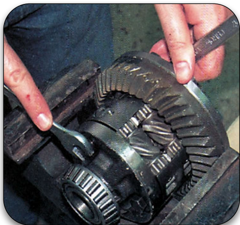
Σχήμα 1.38: Αφαίρεση κεντρικού πλανητικού συστήματος από την κορόνα.
