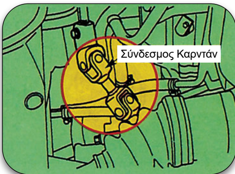
Σχήμα 2.27: Αφαίρεση συνδέσμων καρντάν.
