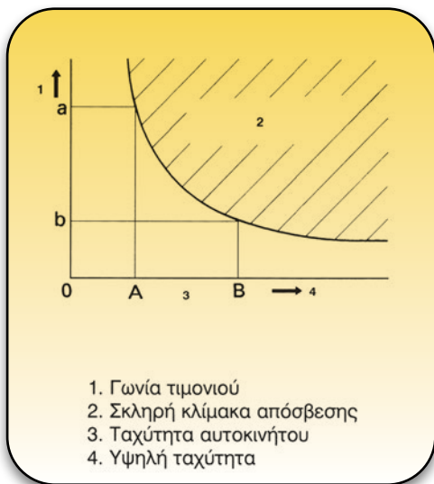
Σχήμα 3.12: Γράφημα σχέσης αισθητήρα γωνίας τιμονιού - αισθητήρα ταχύτητας και απόσβεσης.
